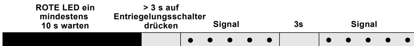
Die Impulse der LED erzeugen ein Signal in einem Zeitabstand von ca. 3 Sekunden.
